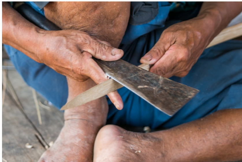
นำหุตะกร้ามาเหลาปลายให้แหลม
